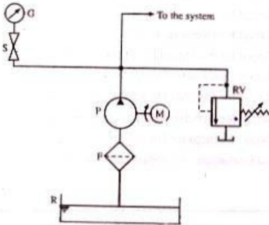
**Fig. 7.1 : Hydraulic power unit**
