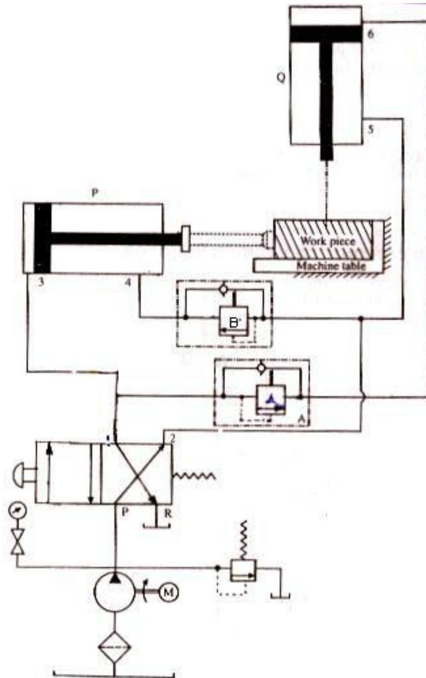
Fig. 7.10 : Sequence circuit
